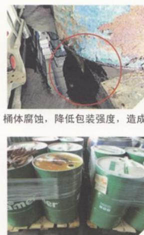
桶体腐蚀，降低包装强度，造成泄漏
