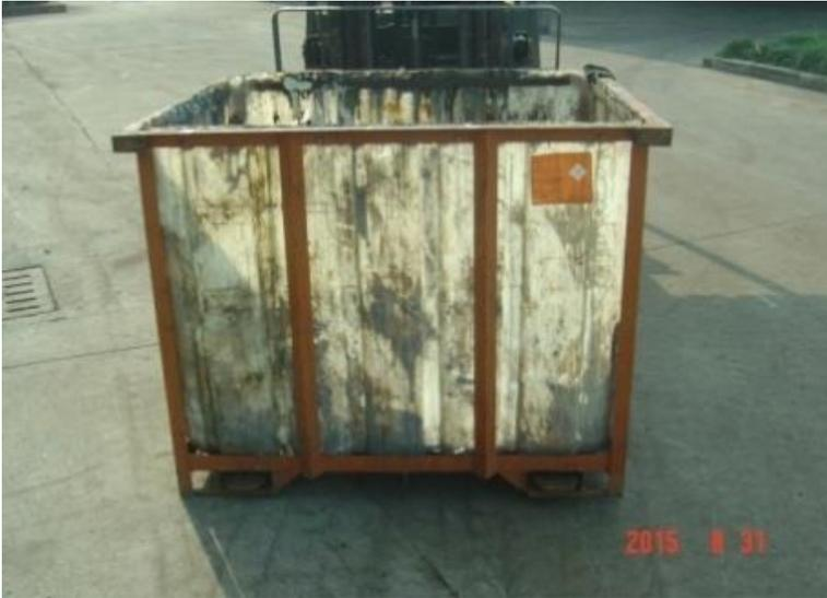
2. 渗漏风险较小的污泥，可用编织袋包装后，再放在吨桶中，双重防护减少渗漏危害。
