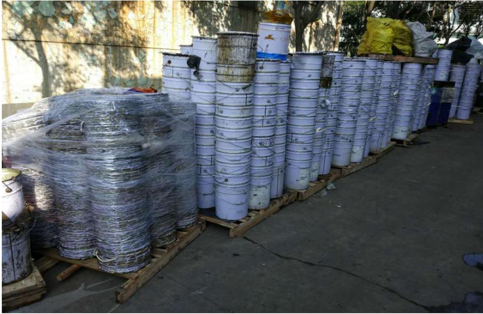
要求：堆放在栈板上，可以用缠绕膜固定，桶盖去掉后桶进行叠加，盖再单独叠加。
